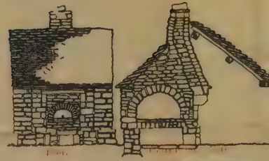
Cheminée et four
