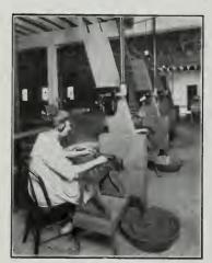
STRIPS ARE FINELY SHREDDED BY SPECIAL DEVICE
