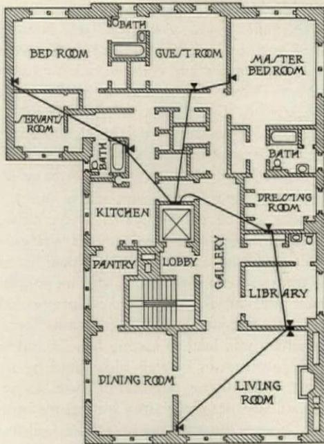
■ Terminal Cabinet   ■ Telephone Outlet   — Conduit
