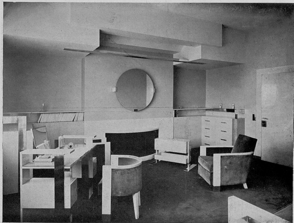
En haut: salle à manger. Murs et sol en marbre vert de Suède, meubles en poirier noir verni, sièges recouverts en cuir beige rosé, éclairage indirect à 3 allumages suivant les dimensions de la table. Portes et fenêtres à coulisses.
