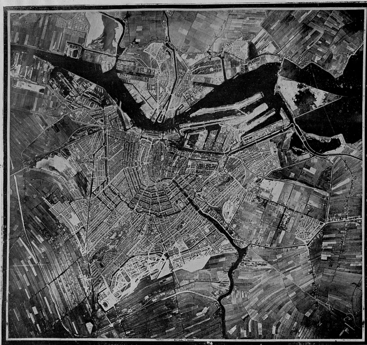
EN HAUT: CARTE AÉRONAUTIQUE, PRISE EN JUILLET 1928, PAR LE SERVICE D'AVIATION MILITAIRE, QUI MONTRE CE QUI A ÉTÉ CONSTRUIT ET EFFECTUÉ DES EXTENSIONS AUX DIFFÉRENTS COTÉS DE LA VILLE. LES TACHES BLANCHES MARQUENT LE PROGRÈS DU REHAUSSEMENT DU SOL AVEC DU SABLE. LA LIGNE BLANCHE ENVIRONNANT LA VILLE À L'OUEST ET AU SUD EST LA LIGNE CEINTURE DU CHEMIN DE FER EN CONSTRUCTION.
