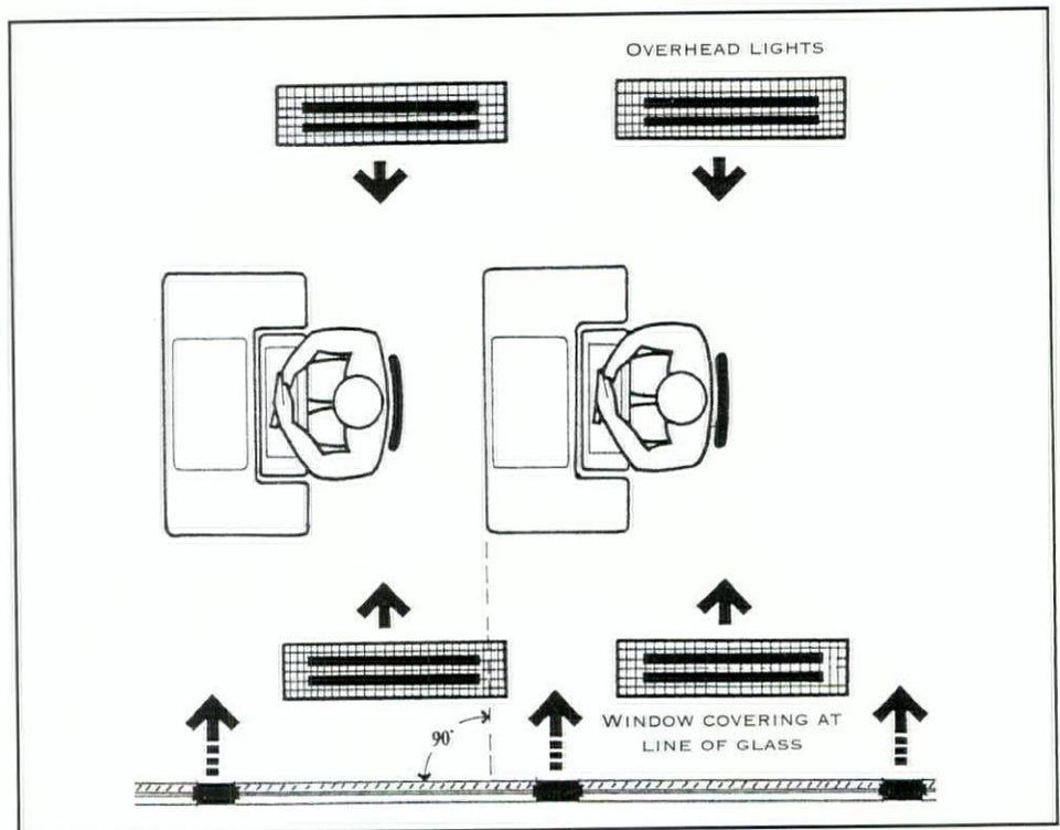
FIGURE 1—IN ORDER TO AVOID GLARE ON THE COMPUTER SCREEN, OVERHEAD LIGHTING FIXTURES SHOULD BE PLACED ON EITHER SIDE OF THE COMPUTER AND SLIGHTLY BEHIND.
