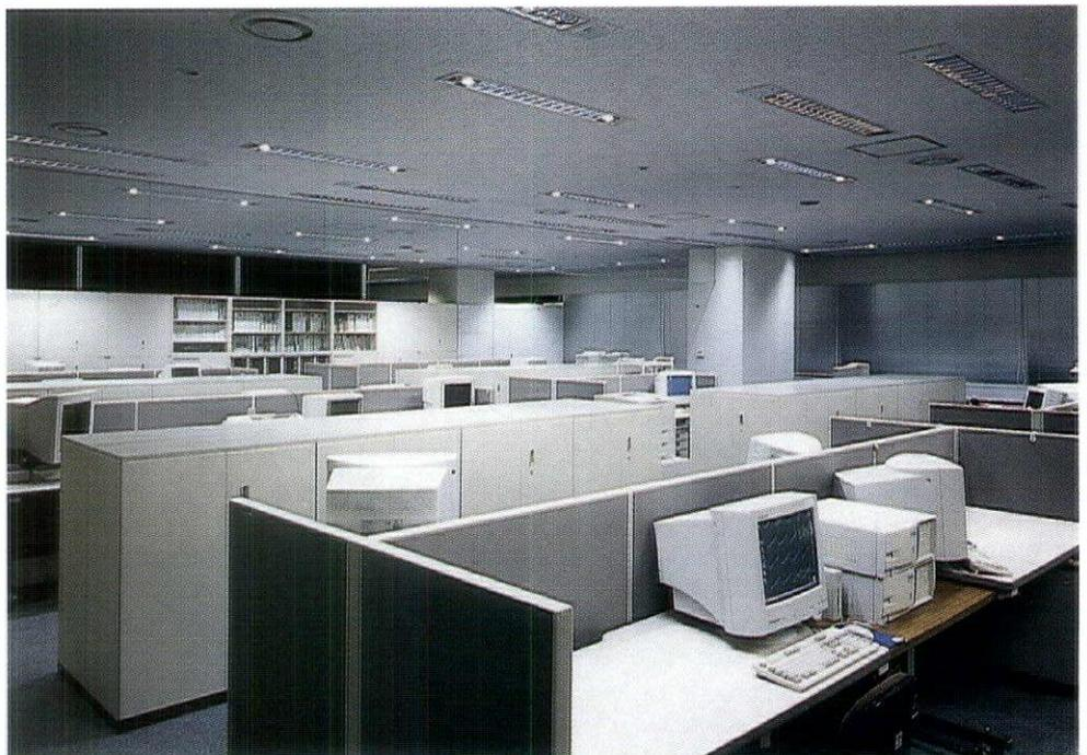
FIGURE 4—AN OFFICE LIGHTED BY A TASK-AND-AMBIENT LIGHTING SYSTEM WITH SPARKLE ELEMENTS. REPRINTED WITH PERMISSION FROM MATSUSHITA ELECTRIC WORKS.
