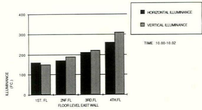
MEASURED HORIZONTAL AND VERTICAL ILLUMINANCE AT THE SITE ON OCTOBER 30 AS A FUNCTION OF FLOOR HEIGHT (2 FEET AWAY FROM WALL AT 5 FEET HEIGHT).
