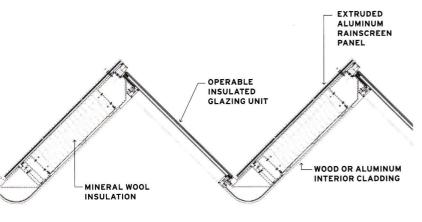
12 IN. TYPICAL DETAIL AT OPERABLE WINDOW 300 MM.
