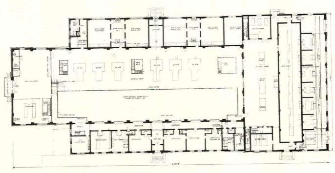
GROUND FLOOR PLAN OF PUMP AND BLOWER HOUSE
