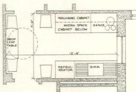
**KITCHEN OF SMALL SIZE;** RANGE ON OPPOSITE WALL FROM SINK; LIGHT ON SINK FROM LEFT. WORK SPACE INDEPENDENT OF PASSAGE BETWEEN DOORS.
