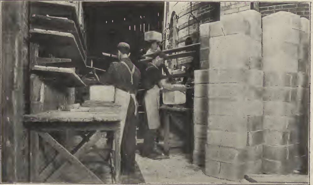
4.—PLACING A KILN.
