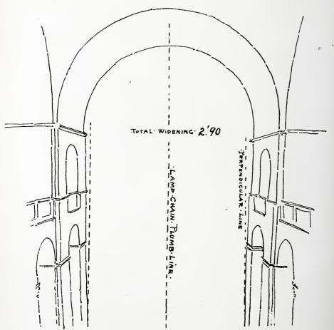
FIG. 2. WIDENING OF THE NAVE IN ST. MARK'S.
