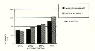
MEASURED HORIZONTAL AND VERTICAL ILLUMINANCE AT THE SITE ON OCTOBER 30 AS A FUNCTION OF FLOOR HEIGHT (2 FEET AWAY FROM WALL AT 5 FEET HEIGHT).
