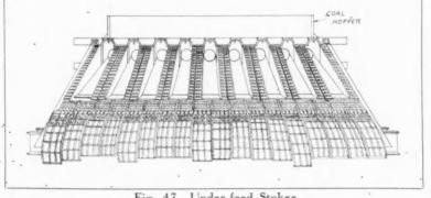
Fig. 47. Under-feed Stoker
